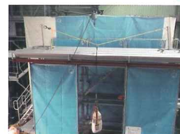
3) 墜落防護工安全基準(第2種)に基づく上さんの静荷重試験
